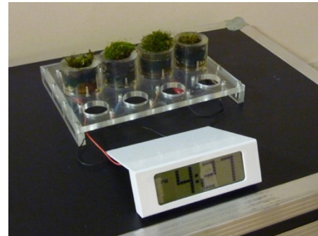
Ilustración 74 Reloj en pantalla LCD funcionando con 4 fotoCCM del tipo "Moss Table"
