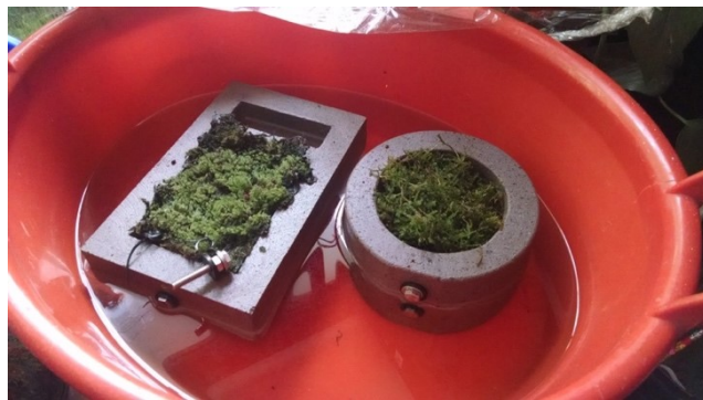
Ilustración 66 Ambas celdas MMC4 en una tina, esta se cubrió con plástico transparente para mantener la humedad
