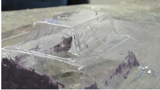
Ilustración 45 Fue difícil lograr que el escalón del contenedor quedara completamente plano, esta es la base para la membrana iónica y cualquier imperfección impide un sello perfecto.
