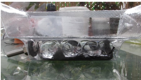
Ilustración 49 Esferas de hidrogel como soporte central de la membrana iónica
