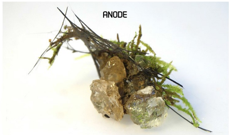
Ilustración 24. Mezcla de componenetes del Anodo
