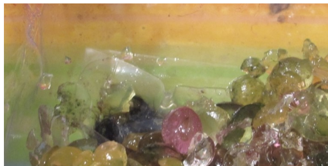
Ilustración 57 Membrana colapsada por peso de cámara anódica
