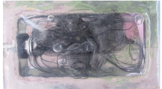
Ilustración 47 burbujas quedaron atrapadas debajo de la membrana, también es difícil sellar completamente la cámara
